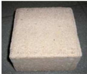
Pavés en béton poreux
