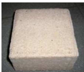
Pavés en béton poreux
