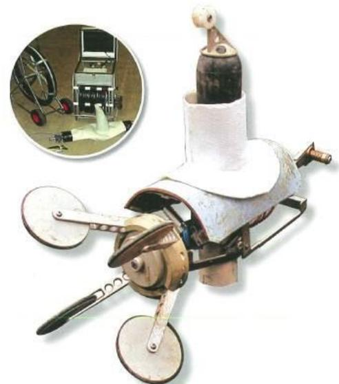
Figure 13 : dispositif utilisé pour la pose d'un top-hat
