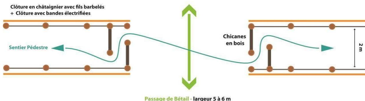
Figure 13 : Schéma de principe d'un passage à bétail. Biotope 2015
